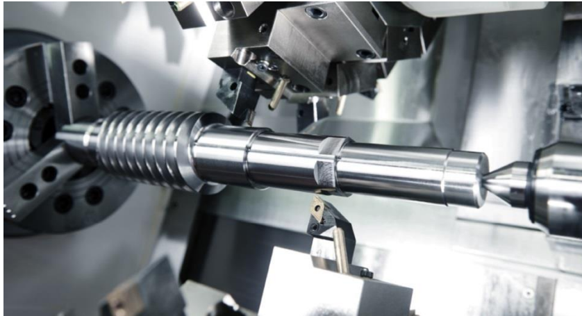
Abbildung 1: Mittels Dreibackenfutter und mitlaufender Spitze fixierte Welle bei der Drehbearbeitung mit zwei Revolvern (Quelle: Plaschka)
